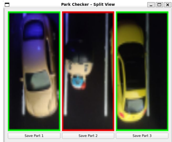
Figura 19. Esempio in cui il modello riesce a distinguere le macchine da persone
